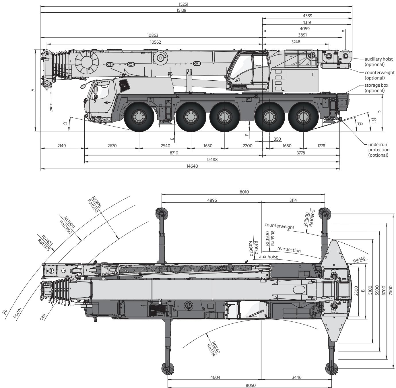
*Ra = Radius all wheels steered. • Radius altradgelenkt. • Rayon toutes les roues directrices. • Radio de giro con todas las ruedas giradas. • Raggio di curva con tutte le ruote sterzate.*
